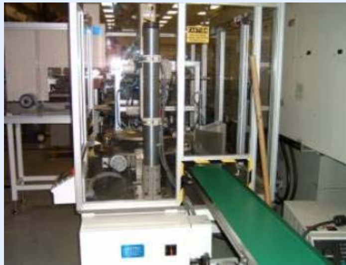
Máquina Automatizada con transportador de salida para partes terminadas
