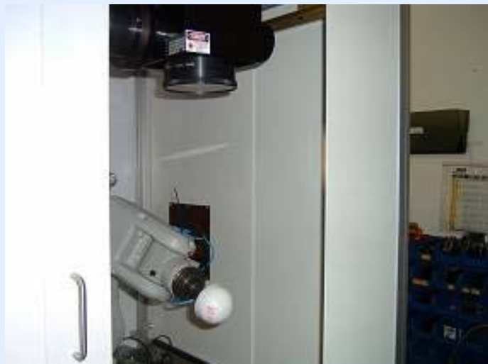
Sistema de Marcado Láser con robot de 6 ejes
