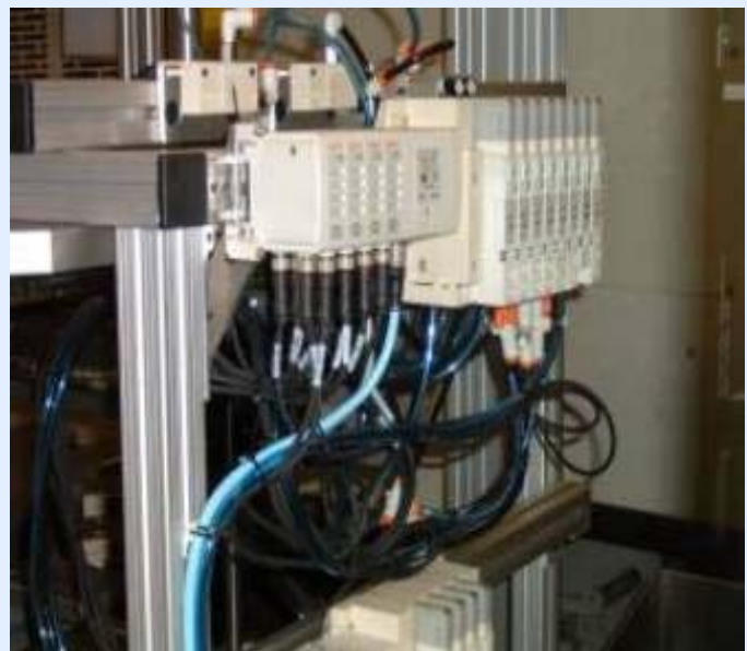
Módulo de entrada/salida para unidad de automatización
