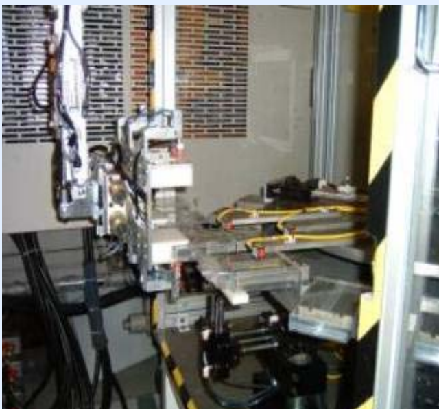
Robot de moldeo cargando partes en la máquina
