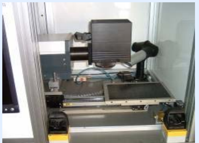
Estación de Precisión X-Y y de cabeza escaneadora de alta velocidad
