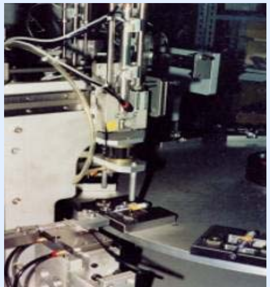
Perno de Alineación para la inserción exacta de la parte
