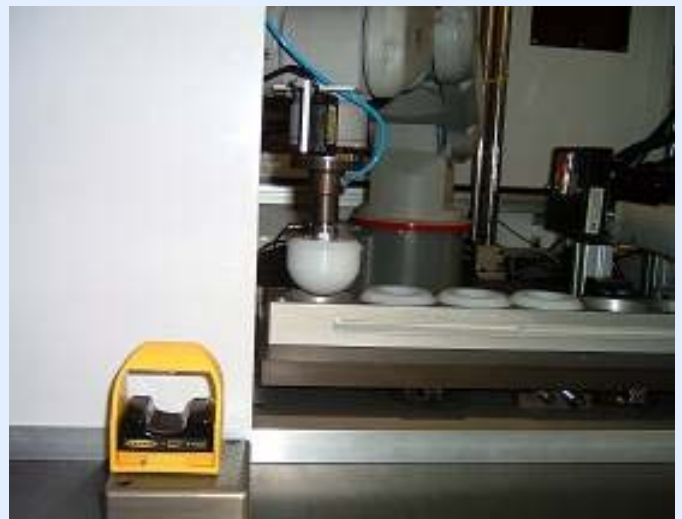
Robot con sensor de parte presente para recojer y colocar automático.
