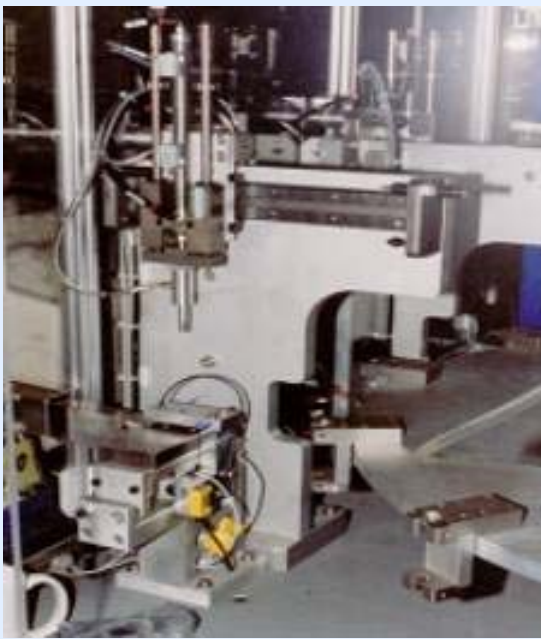
Auto alimentación con lanzador y movimiento X-Z-R de recojer y colocar
