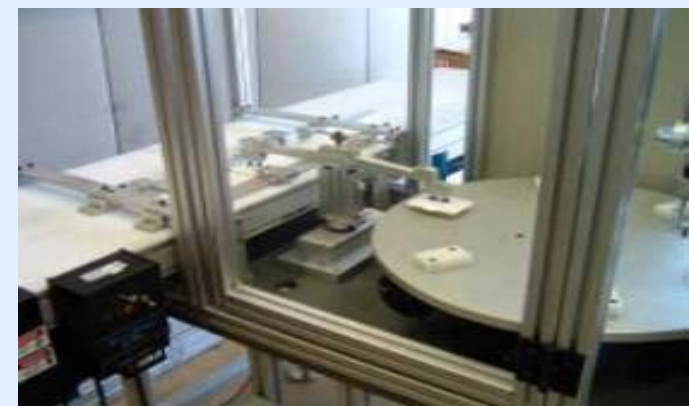
Célula de Fabricación desatendida con transportador de alimentación de partes, separador de partes y dispositivo automático de recoger y colocar para partes nuevas y partes terminadas.
