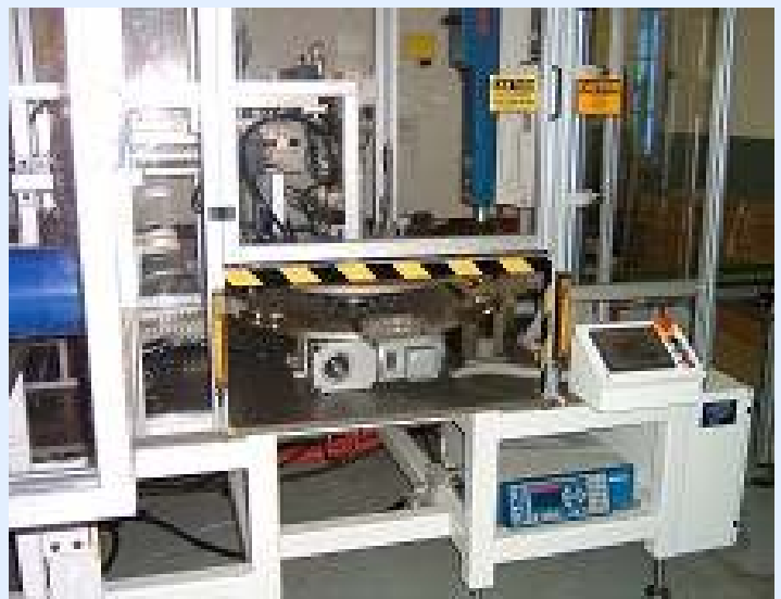
Mesa de Índice Giratorio con estación de soldadura ultrasónica.
